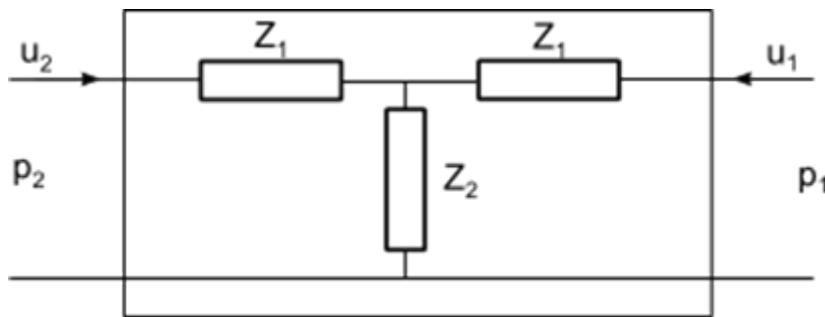
$$\begin{bmatrix} V_2 \\ I_2 \end{bmatrix} = A \begin{bmatrix} V_1 \\ I_1 \end{bmatrix} = \begin{bmatrix} a_{11} & a_{12} \\ a_{21} & a_{22} \end{bmatrix} \begin{bmatrix} V_1 \\ I_1 \end{bmatrix}$$
